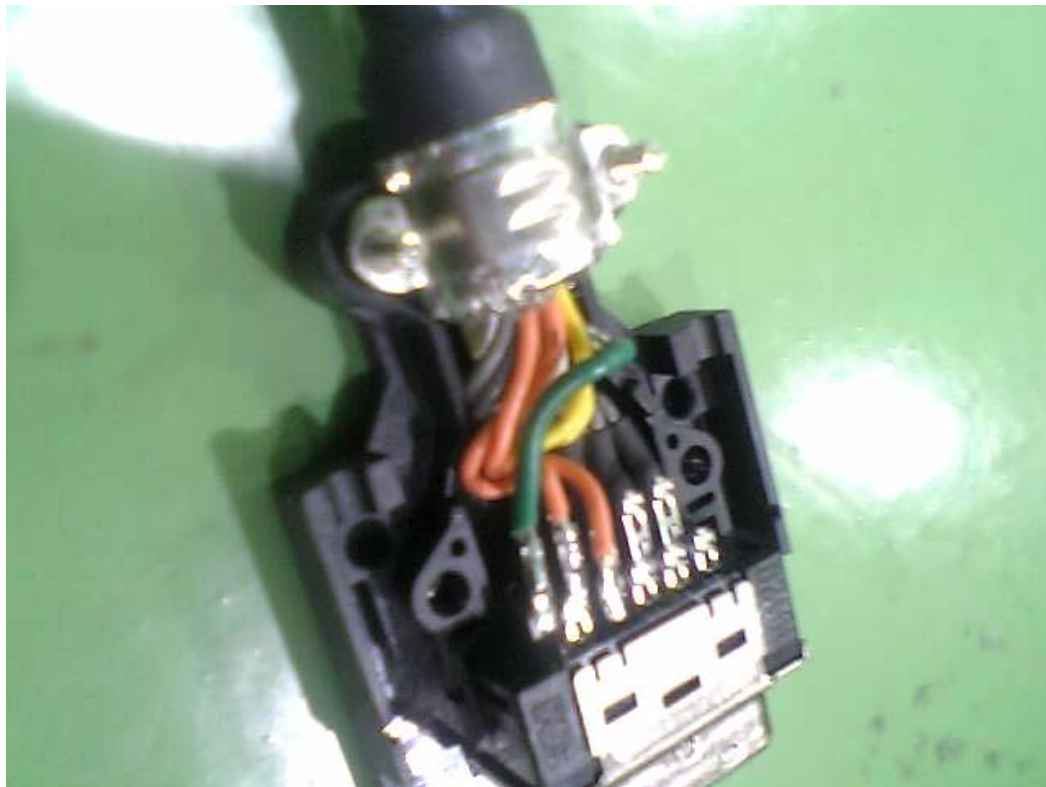
圖 12 驅動器端 SCSI 接頭接法
