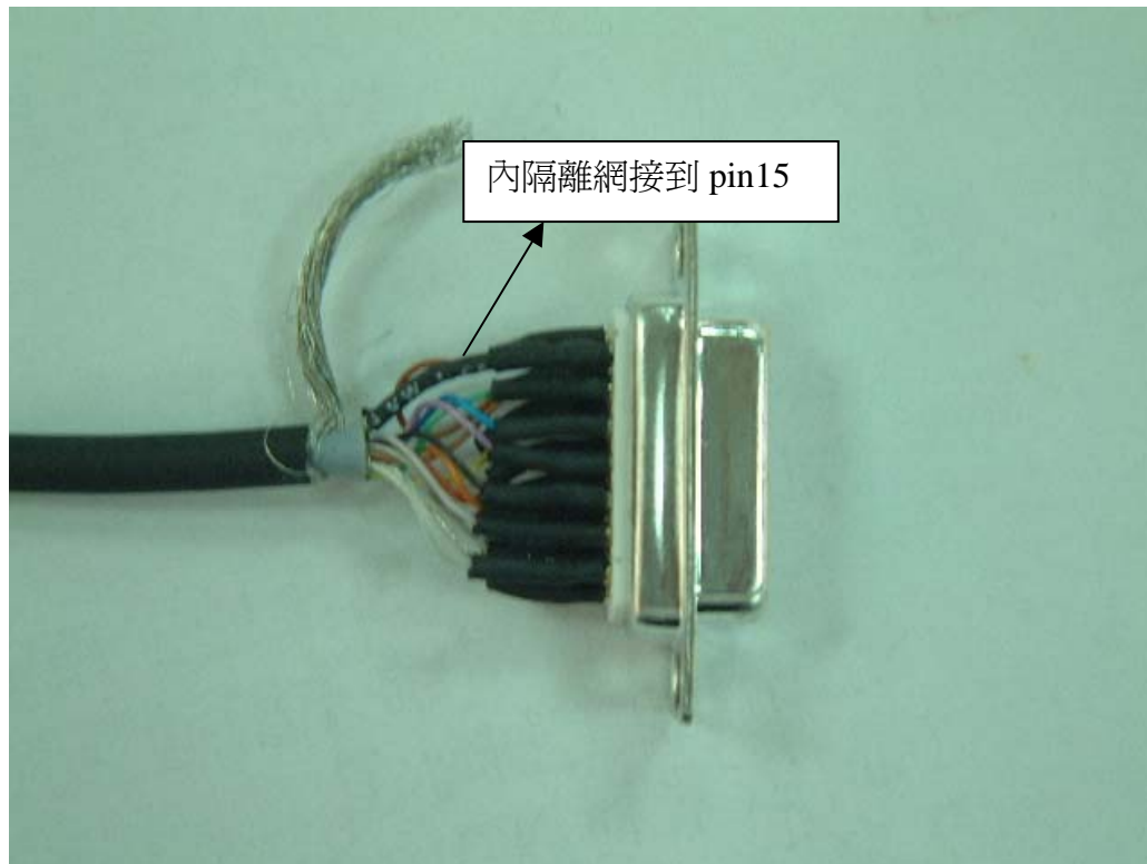
圖 10 動子端 D-SUB 接頭接法,將內隔離網接到 pin 15
